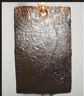
在红锈下面形成的磁铁层
